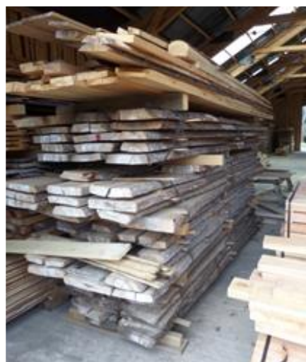
Foto 2: Tablones estacionados en estibas bajo techo
