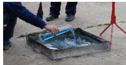
Figura 7: Bandeja testigo (B) con mezcla de agua y 5 litros de nafta.
