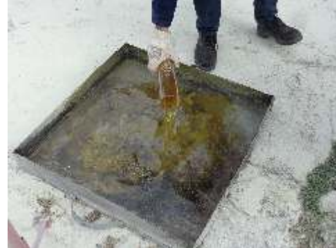
Figura 9: Bandeja de evaluación con combustibles tipo “B”: 2 litros de nafta, 2 litros de gasoil y 1 litro de aceite hidráulico.
