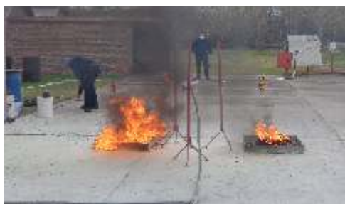
Figura 10: Superior: operario listo para encender las bandejas de evaluación “A” y “B”. Inferior: periodo de combustión de 20 segundos buscando lograr una temperatura importante.
