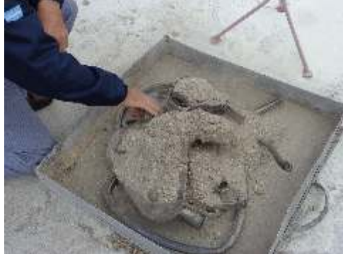
Figura 8: Bandeja de evaluación preparada con combustible tipo “A”: borra de soja mezclada con correas de transmisión y cobertores plásticos de una máquina cosechadora.
