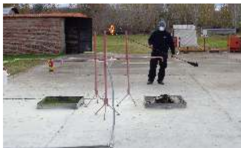
Figura 8: Bandeja de evaluación preparada con combustible tipo “A”: borra de soja mezclada con correas de transmisión y cobertores plásticos de una máquina cosechadora.
