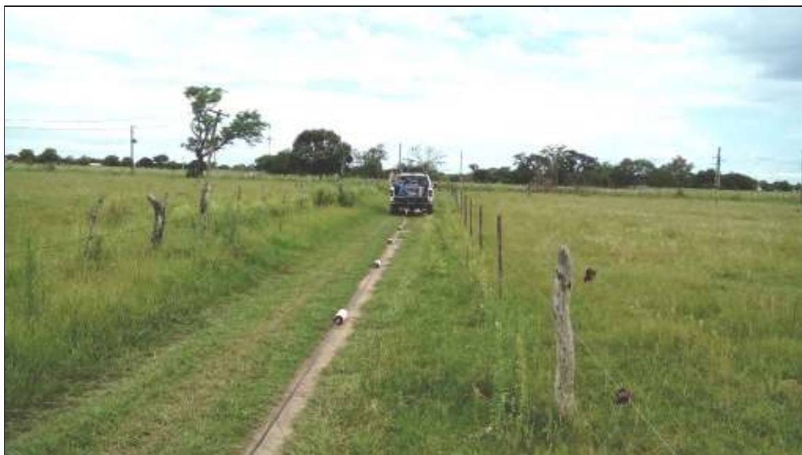
El equipo de prospección utilizado siendo halado en este caso por una camioneta.
