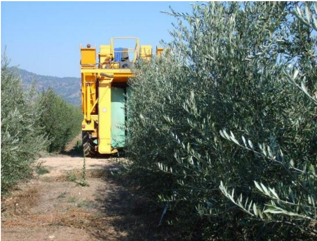
Fig. 8. Olivar Súper-intensivo cosechado mecánicamente con el uso de máquinas de tipo cabalgantes “viñateras”. VII Región. Chile.
