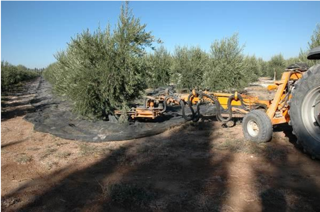
Fig. 5. Olivar intensivo de baja densidad cosechado mecánicamente a través de una pinza vibradora adaptada al sistema hidráulico del tractor. Sarmiento, San Juan. Argentina
