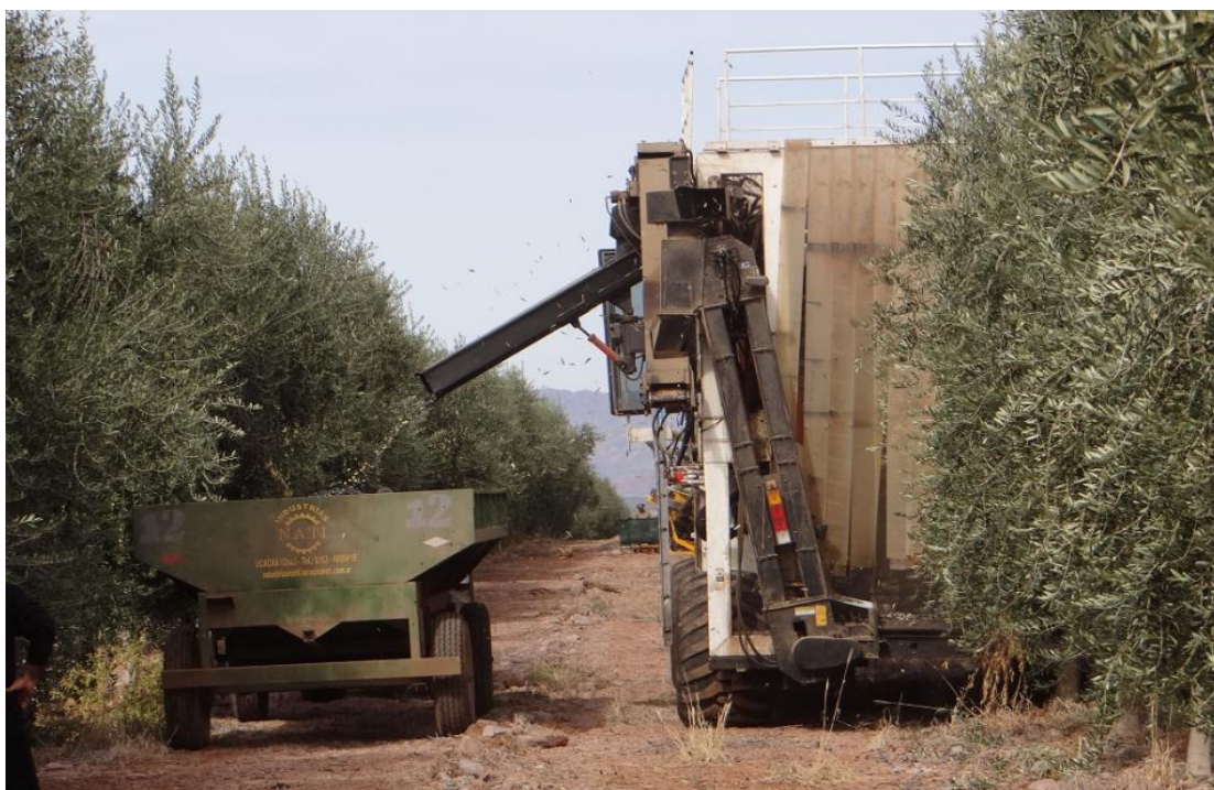
Fig. 7. Cosecha mecánica de un olivar intensivo con Colossus. Chilecito, La Rioja. Argentina.
