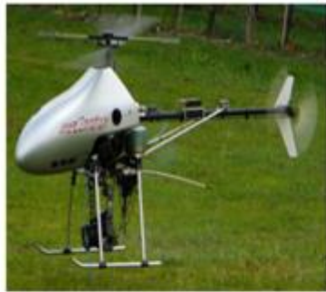
Figure 2: Mini UAV of weControl (Zurich) with the RGB sensor Canon EOS 20D. Nebiker et al., 2008
